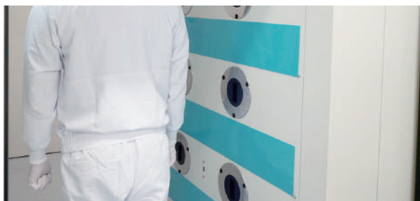
エアシャワーの除塵を手助けする 壁面用粘着シート
