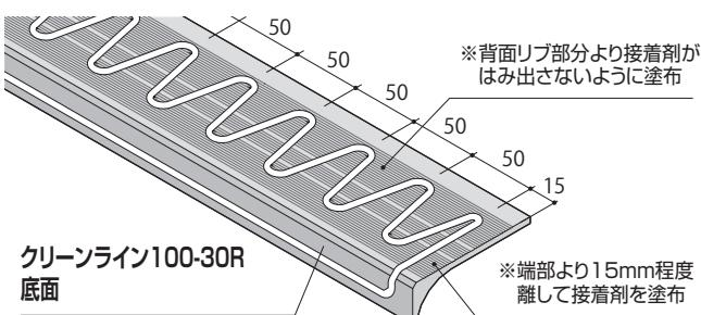
△注意 ●底面側段差調整具合に応じて、接着剤の塗布量を増やしてください。
