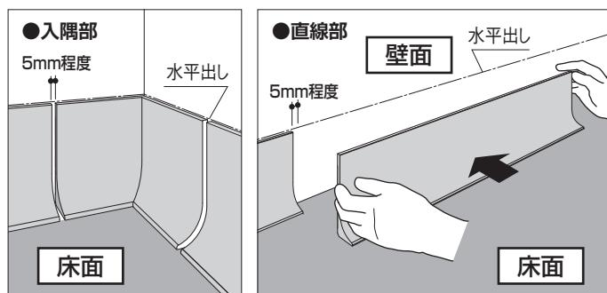
△注意 ●製品と製品の隙間を5mm程度空けるようにしてください。隙間を空けないと施工すると、室内の温度上昇時、製品が伸びることにより製品が割れことがあります。
