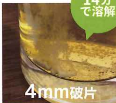
パイプ内のスケール破片溶解実験
